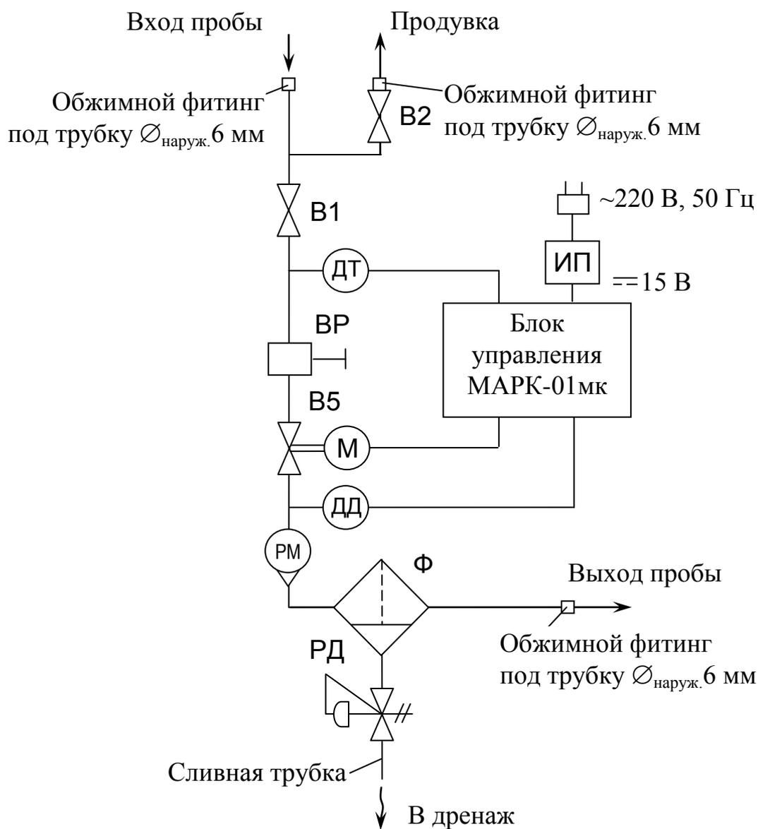
Рисунок 1.1 – Схема функциональная МАРК-01мк 7/40 и МАРК-01мк 32/40
