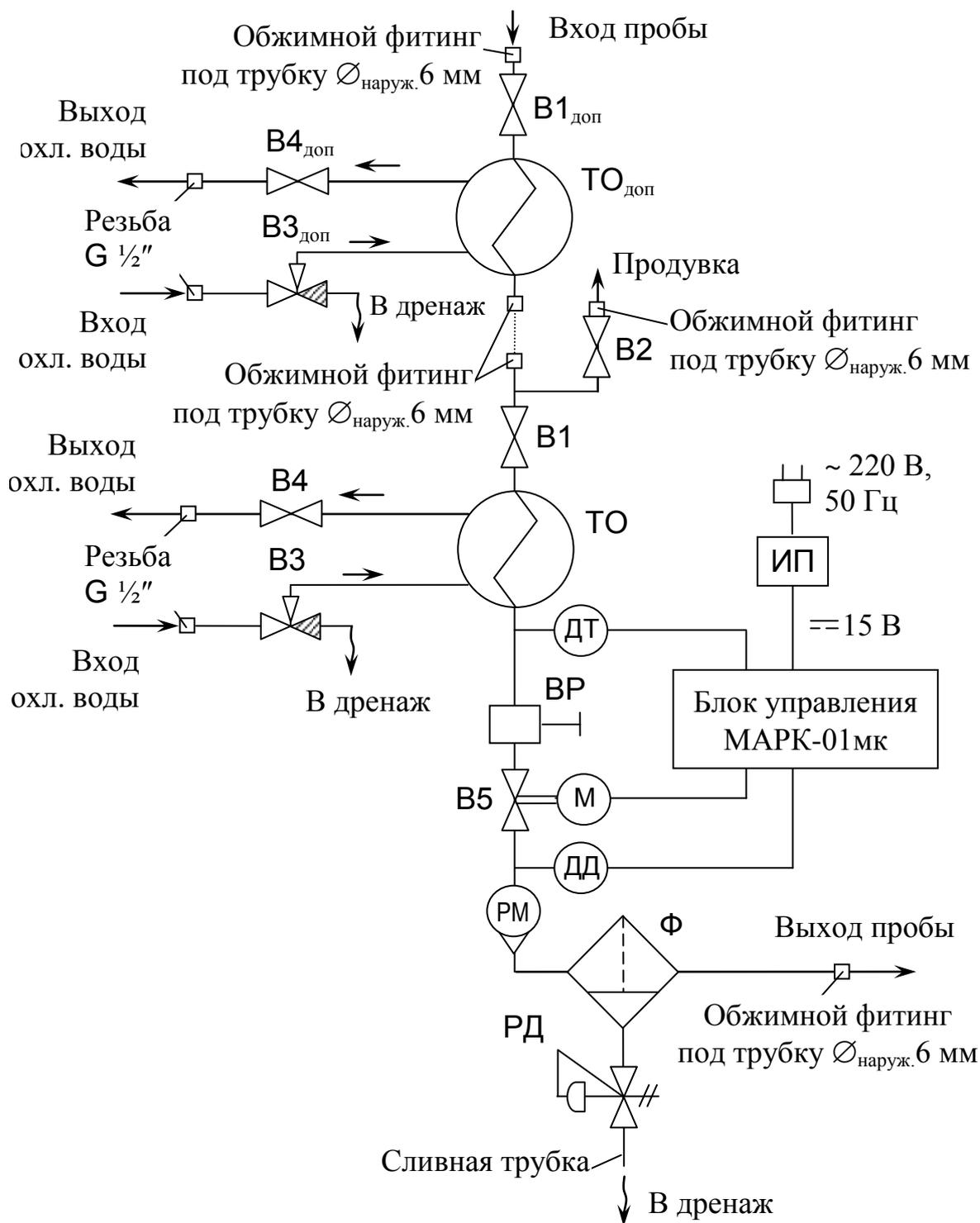
Рисунок 1.5 – Схема функциональная МАРК-01мк 7/560 и МАРК-01мк 32/560
