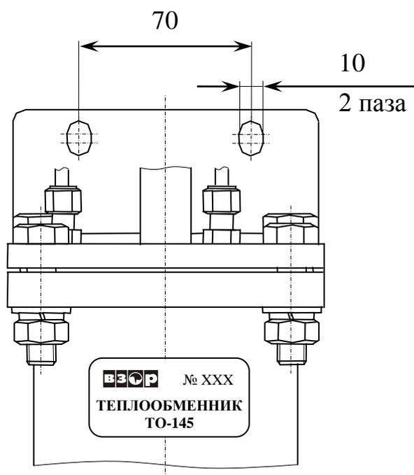
Рисунок 2.2 – Расположение отверстий на кронштейне крепления дополнительного теплообменника
