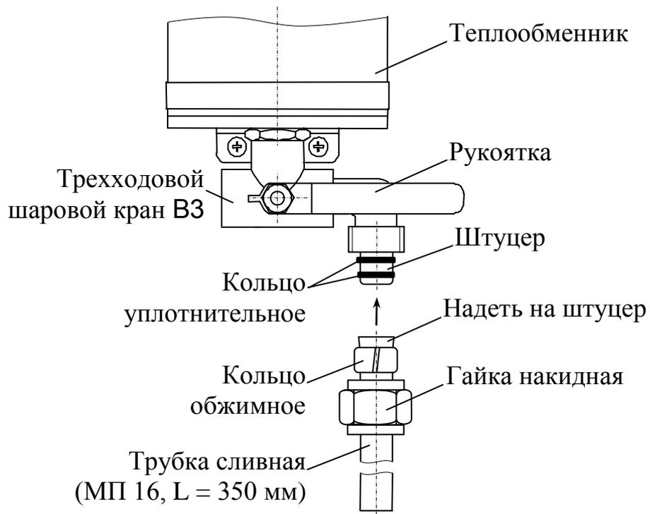
Рисунок 2.11 – Подсоединение сливной трубки к теплообменнику
