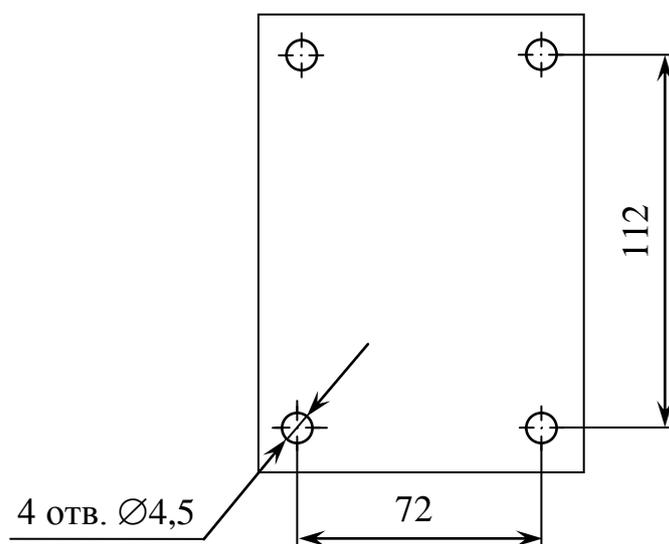
Рисунок 2.5 – Расположение отверстий для крепления источника питания ИП-01мк
