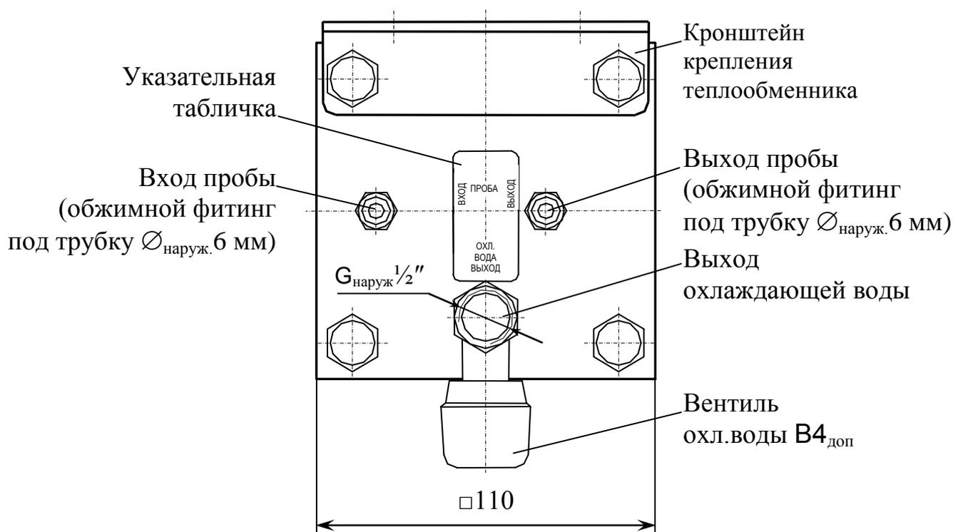
Рисунок 1.7 – Теплообменник базовой комплектации (вид сверху)
