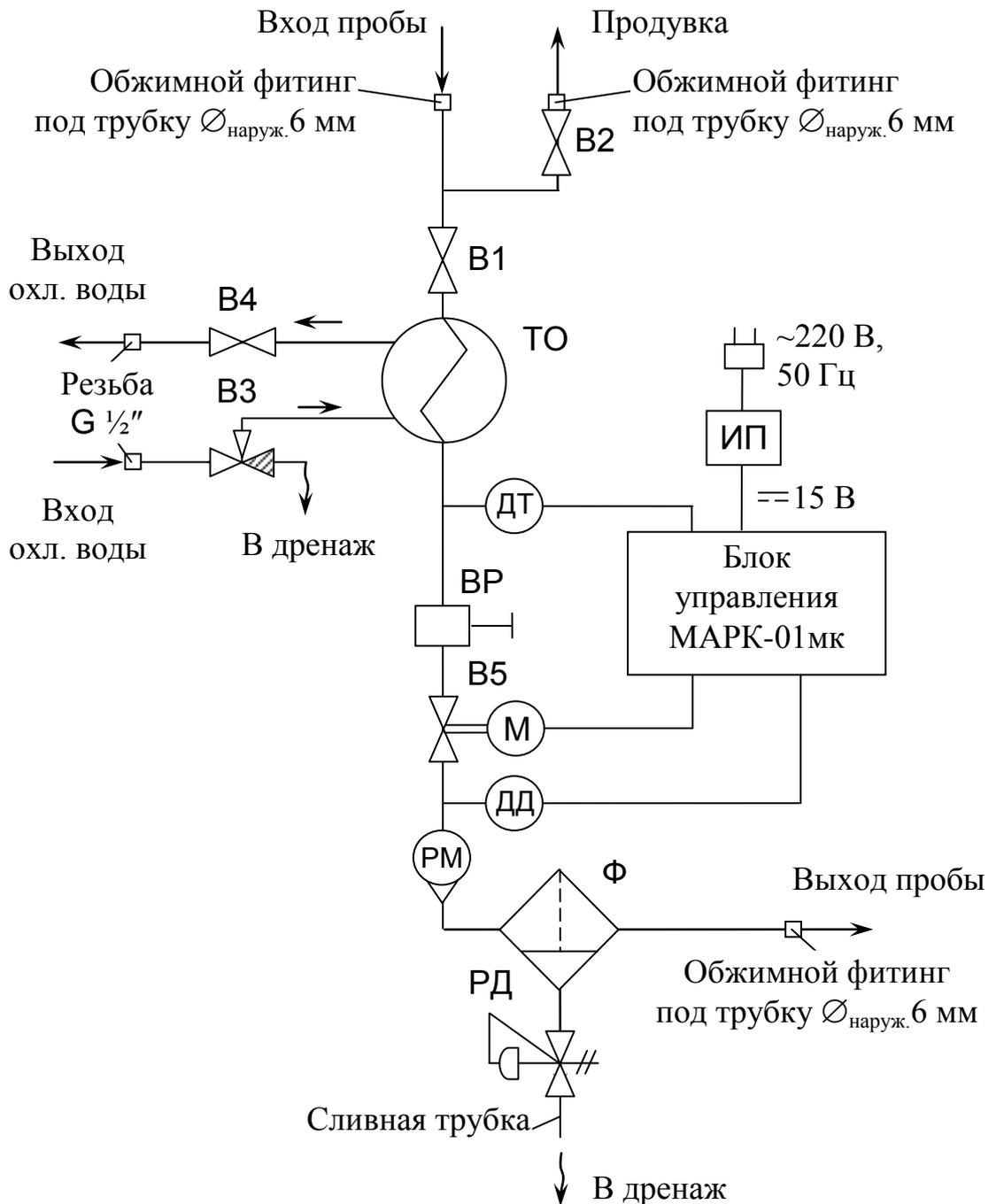
Рисунок 1.3 – Схема функциональная МАРК-01мк 7/250 и МАРК-01мк 32/250
