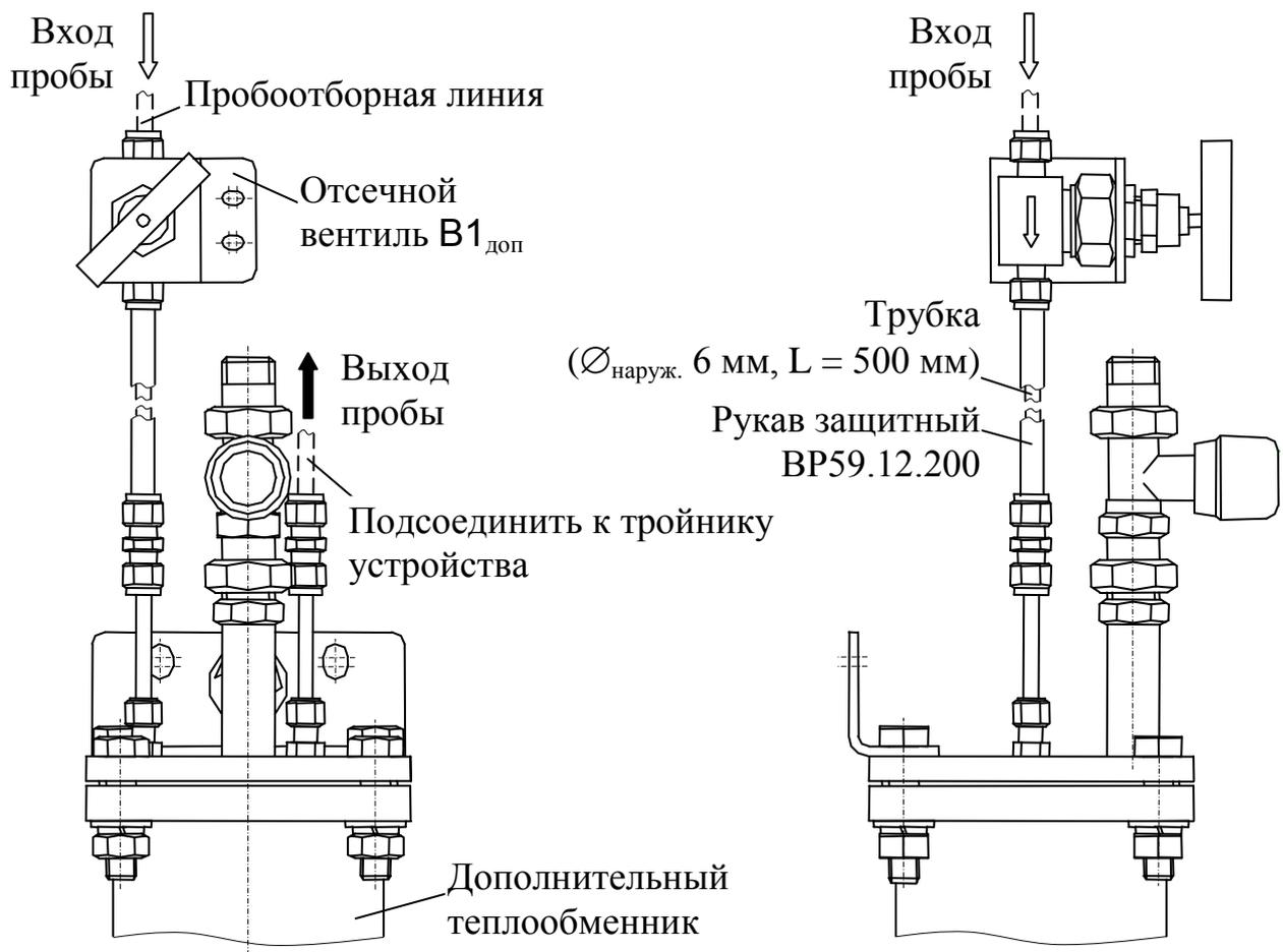
Рисунок 2.9 – Дополнительный теплообменник с входным вентилем
