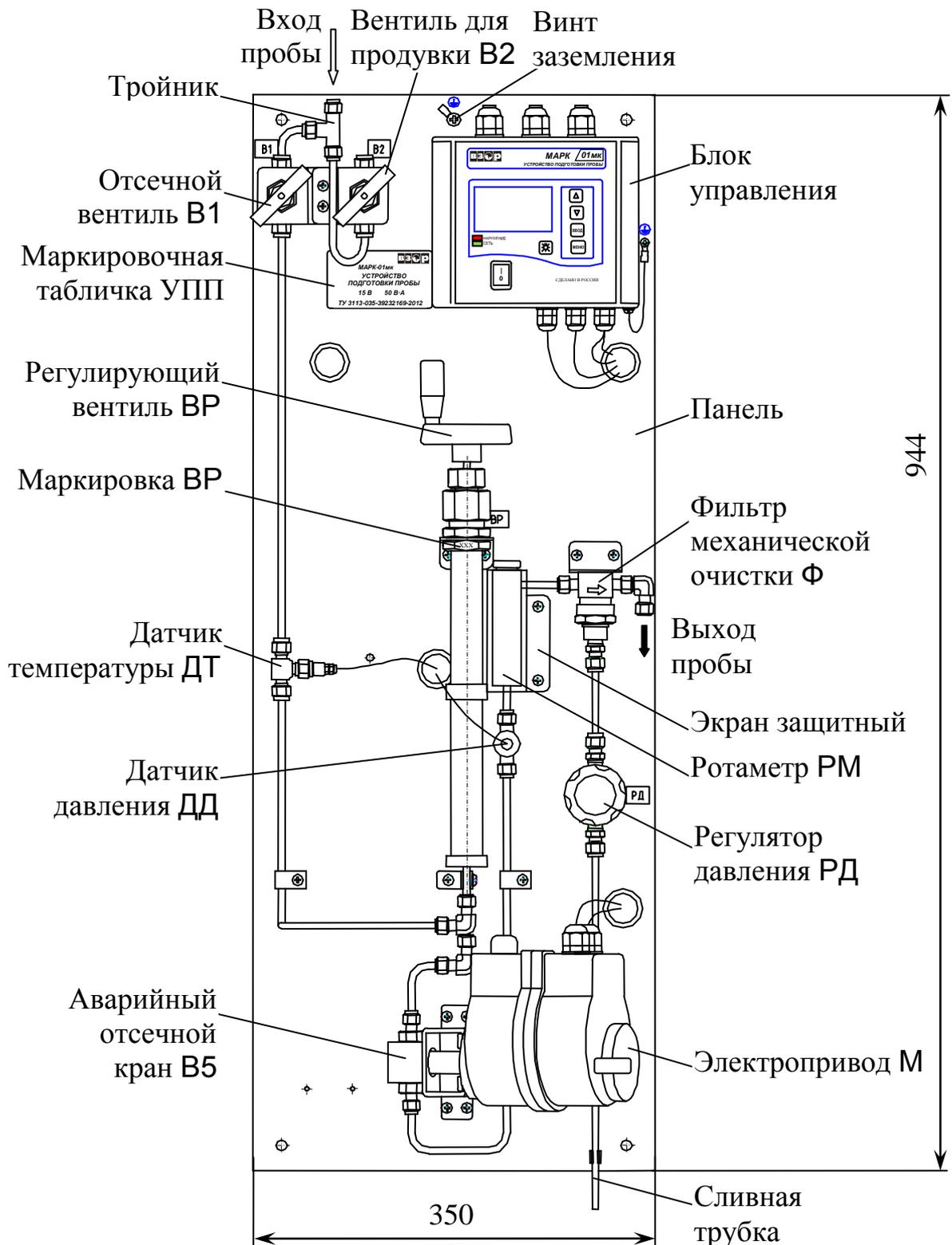
Рисунок 1.2 – Основные конструктивные элементы и габаритные размеры МАРК-01мк 7/40 и МАРК-01мк 32/40
