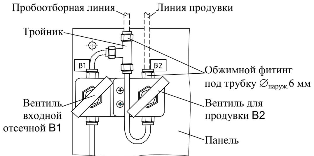
Рисунок 2.6 – Подсоединение пробоотборной линии и линии продувки
