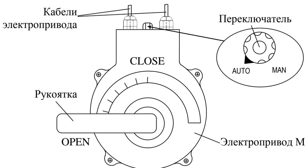
Рисунок 1.15 – Электропривод аварийного отсечного крана (вид сбоку)
