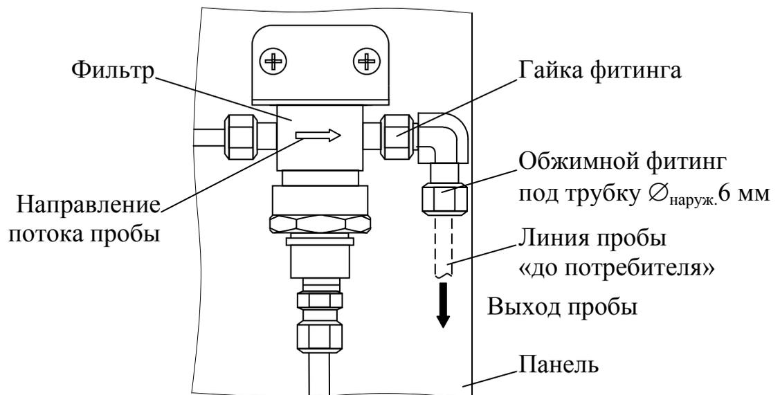
Рисунок 2.7 – Подсоединение линии пробы «до потребителя»
