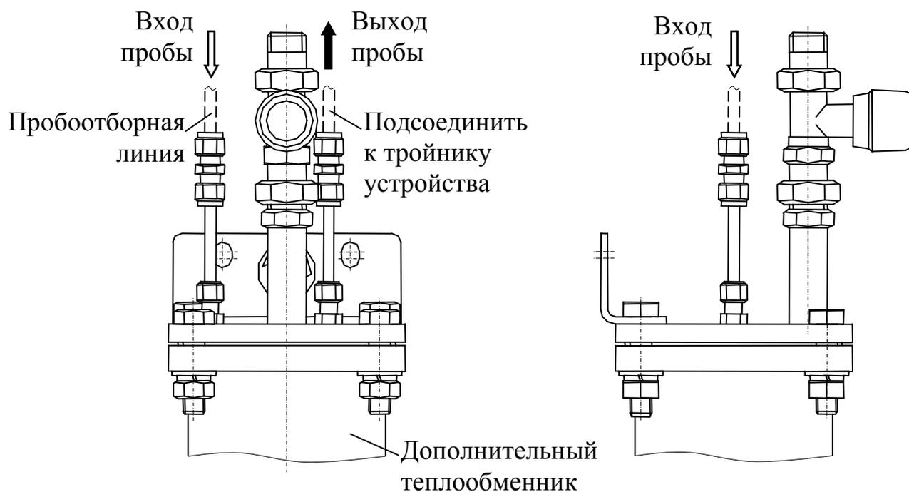
Рисунок 2.8 – Дополнительный теплообменник без входного вентиля
