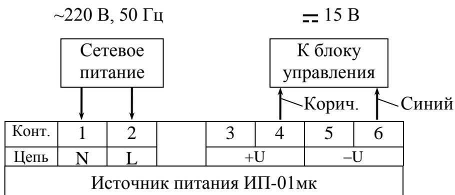
Рисунок 2.14 – Схема подсоединения кабелей к источнику питания ИП-01мк
