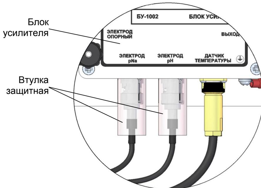
*Рисунок 2.9 – Расположение втулок защитных на разъемах натриевого и рН-электродов (местный вид)*
