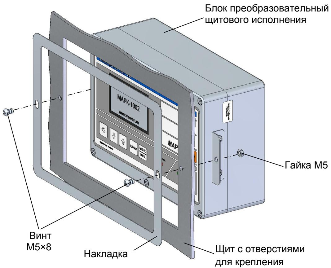
Рисунок 2.2 – Установка блока преобразовательного щитового исполнения
