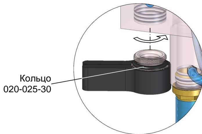
*Рисунок 3.33 – Замена фильтрующего материала (местный вид)*
