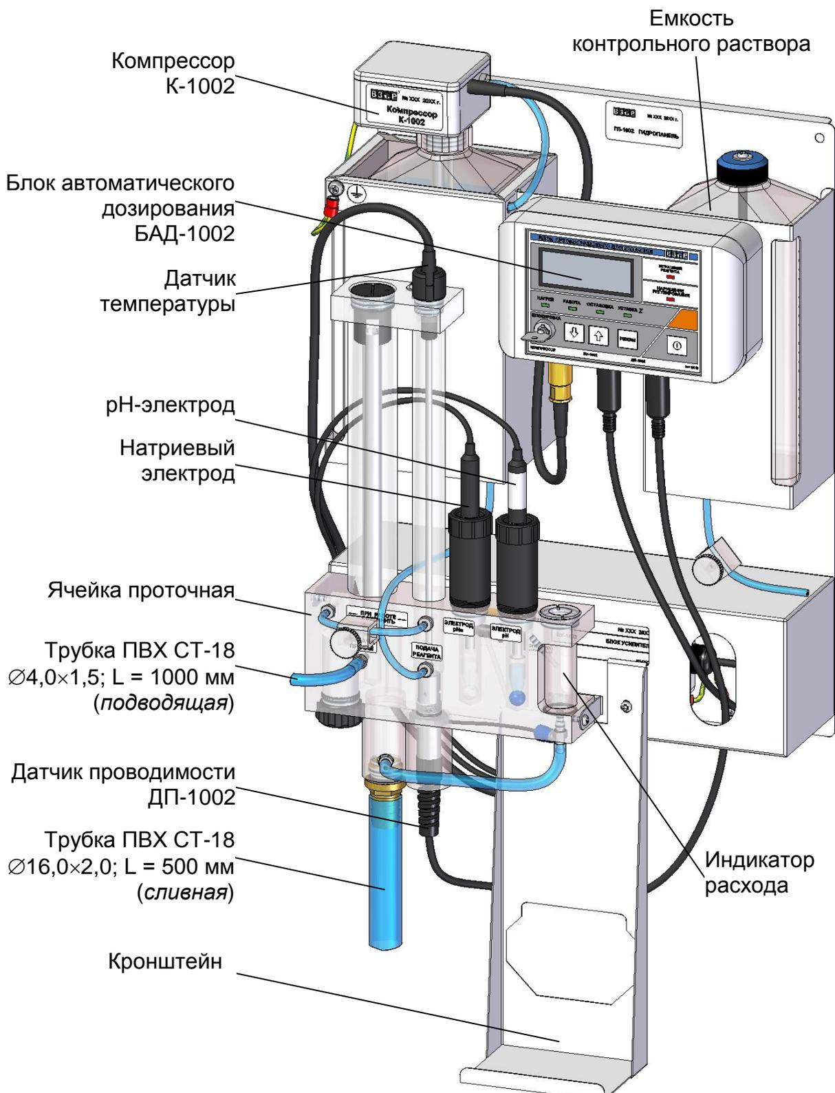
Рисунок 1.5 – Гидропанель ГП-1002
