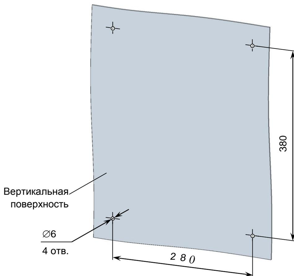
*Рисунок 2.6 – Расположение и размер отверстий для крепления гидропанели*
