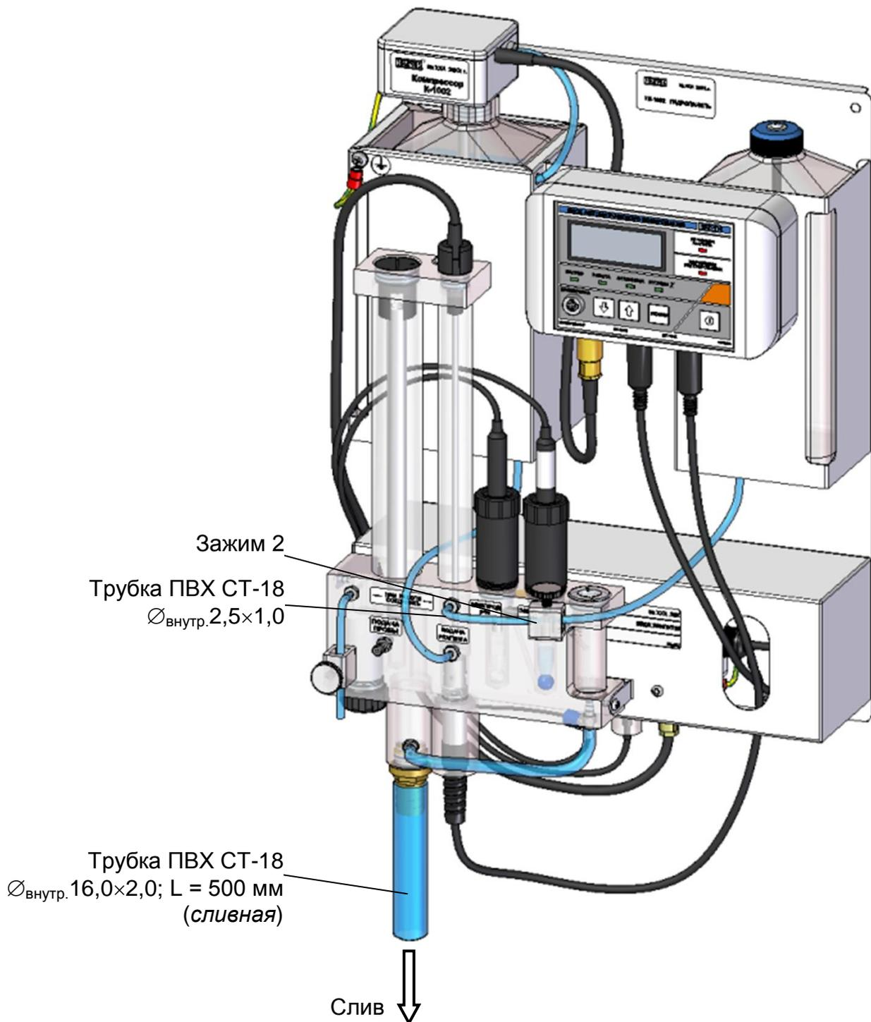
Рисунок 2.11 – Заполнение гидропанели ГП-1002 дистиллированной водой
