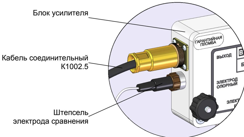
Рисунок 3.4 – Подключение электрода сравнения к блоку усилителя
