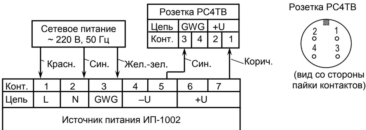
Рисунок 1.9 – Схема соединений источника питания ИП-1002
