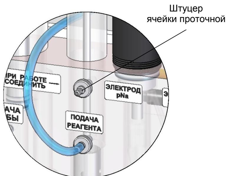
Рисунок 3.1 – Штуцер ячейки проточной гидропанели ГП-1002
