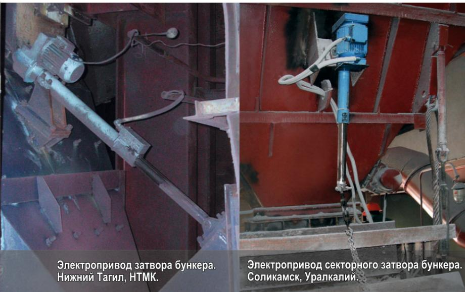
Электропривод затвора бункера. Нижний Тагил, НТМК.
