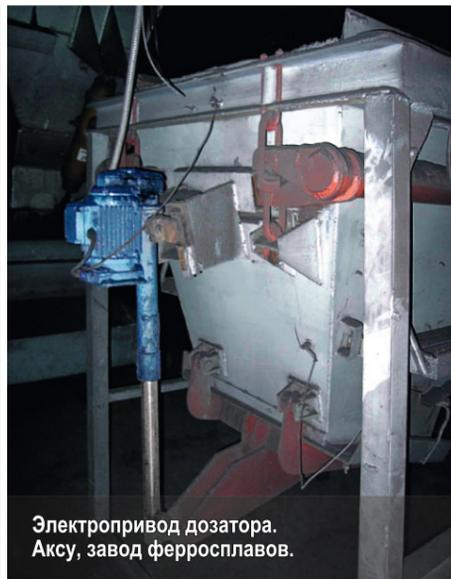
Электропривод дозатора. Аксу, завод ферросплавов.
