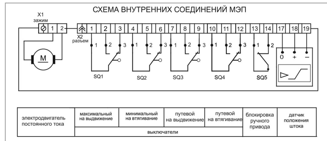
X1-1, X1-2 - клеммный зажим с резьбовыми шпильками
